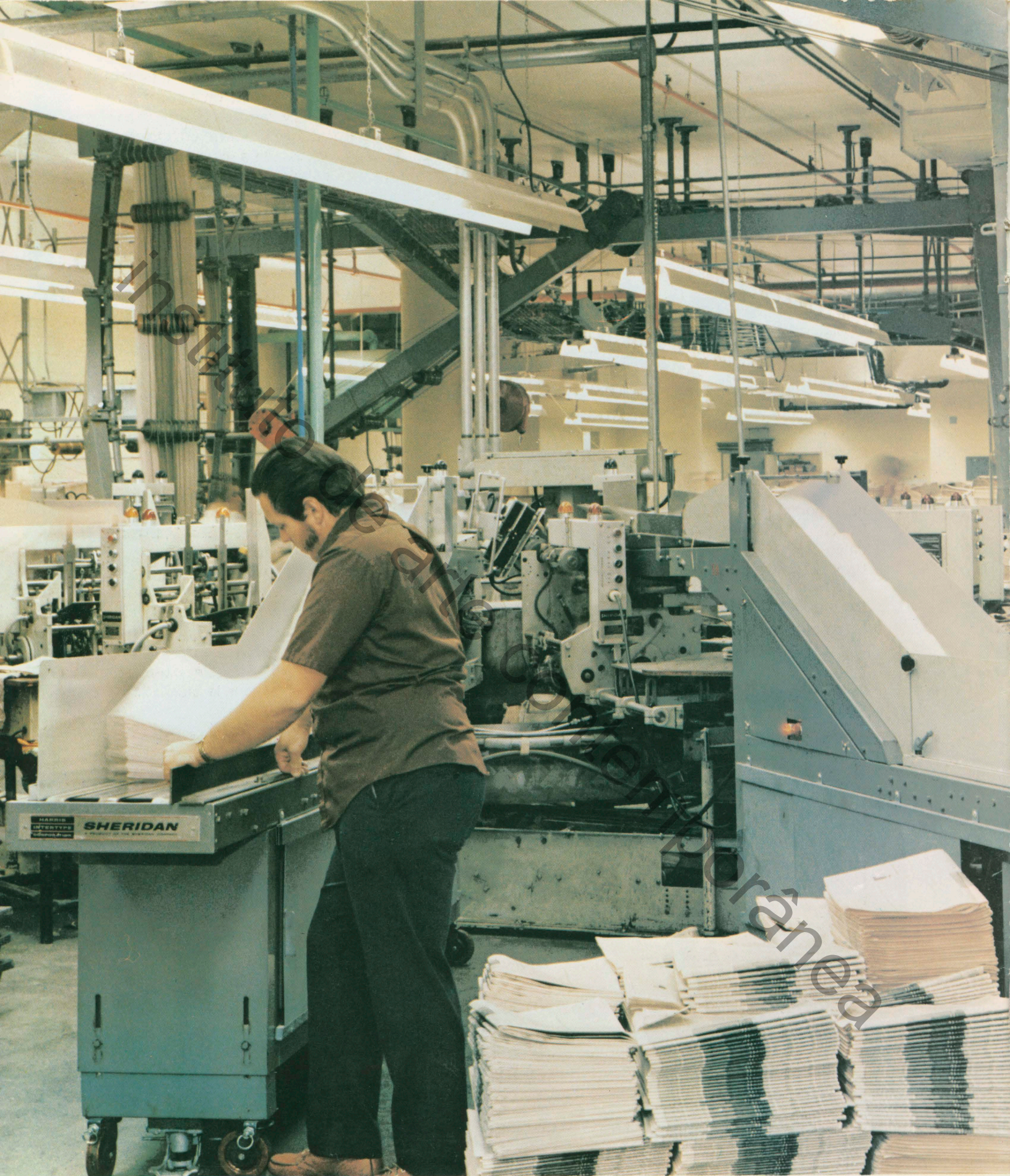
Las máquinas Intercaladoras Sheridan 72-P instaladas en el Chronicle , de Houston, funcionan en línea con la rotativa y alimentan un sistema de expedición controlado mediante computadora.
